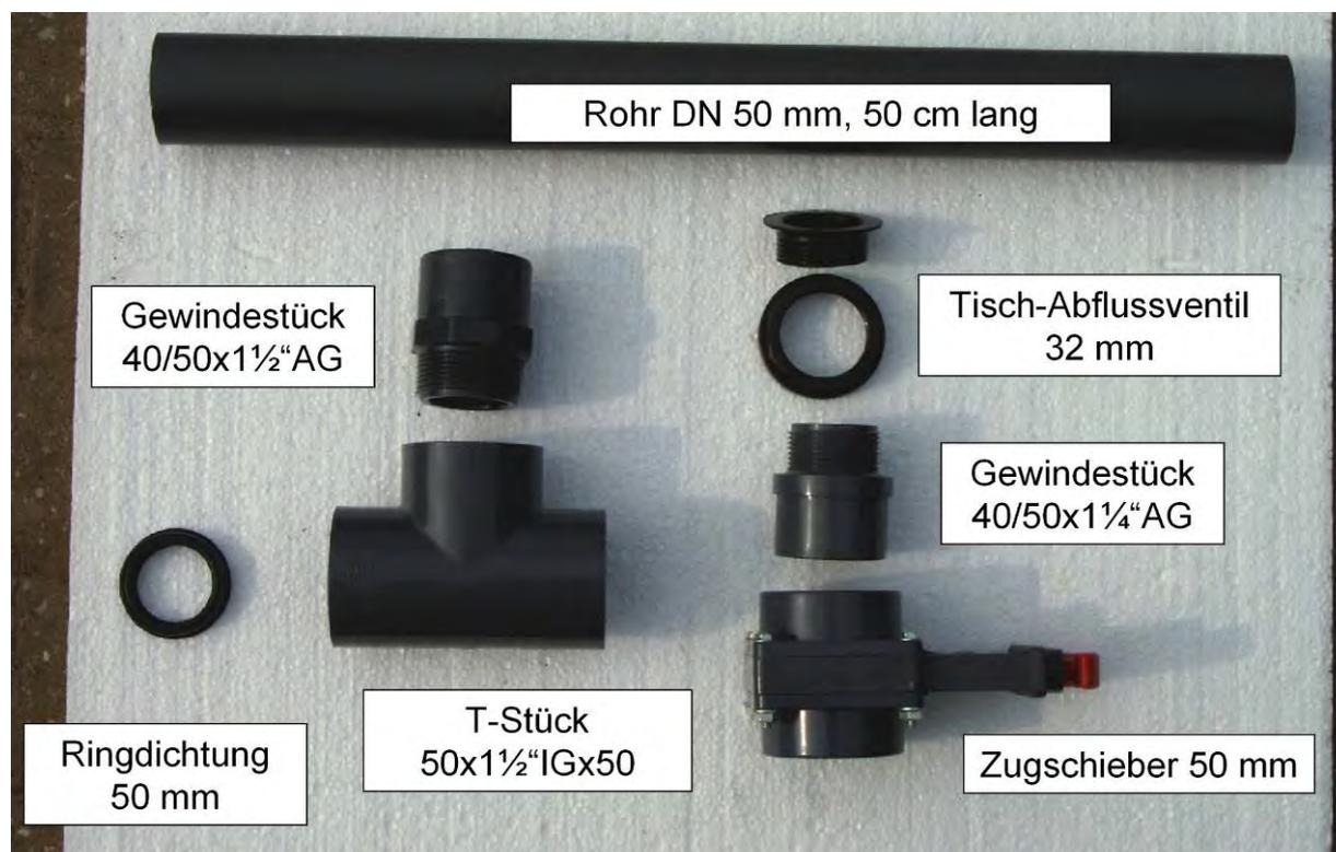
Abb. 77: Bauteile des Akkugebläses
