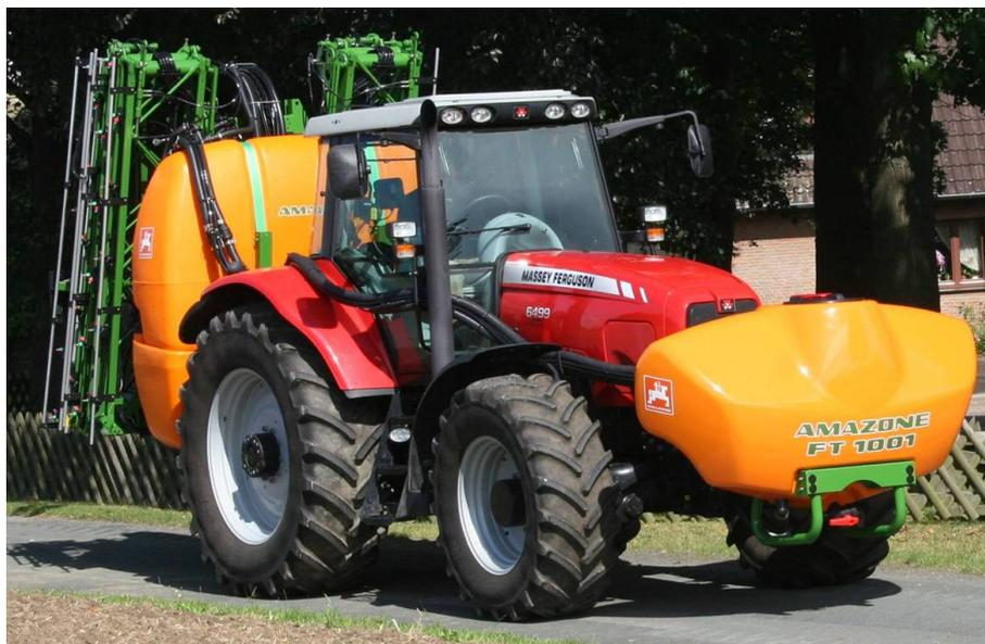
Abb. 1: Anbaugerät mit Fronttank zur Frontballastierung und Erhöhung der Schlagkraft (Werkfoto: Amazone)
