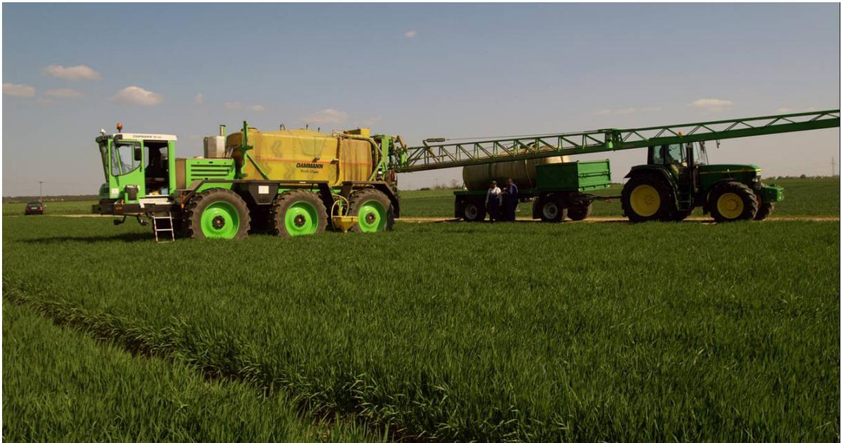
Abb. 3: Selbstfahrer mit 10.000 l-Behälter in 3achs-Ausführung
