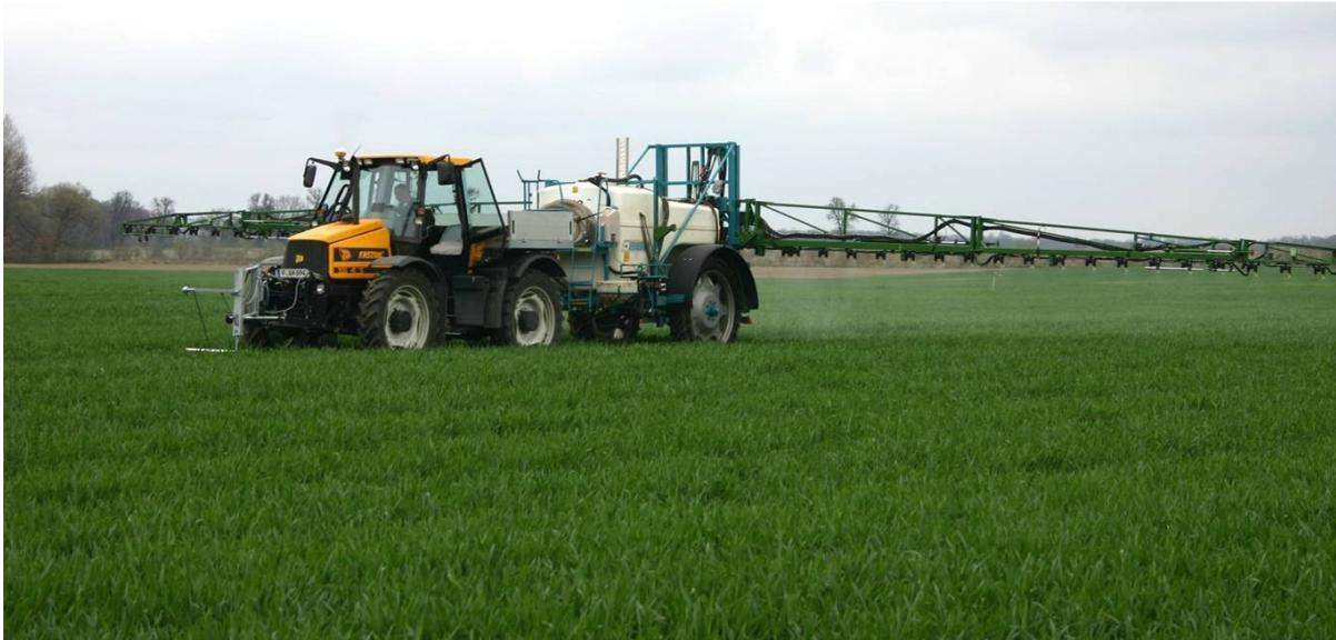
Abb. 4: Anhängespritzgerät mit Coptiliter gesteuerter Fungizid/Wachstumsregler-Applikation (Foto: ATB-Potsdam)
