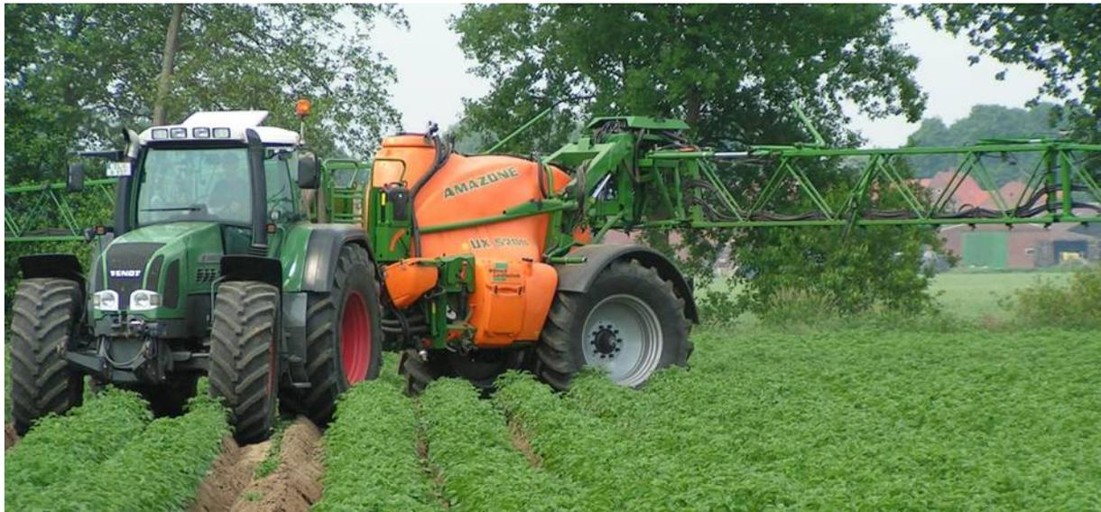
Abb. 2 Anhängegerät mit Achsschenkelenkung für spurtreuen Nachlauf (Werkfoto: Amazone)
