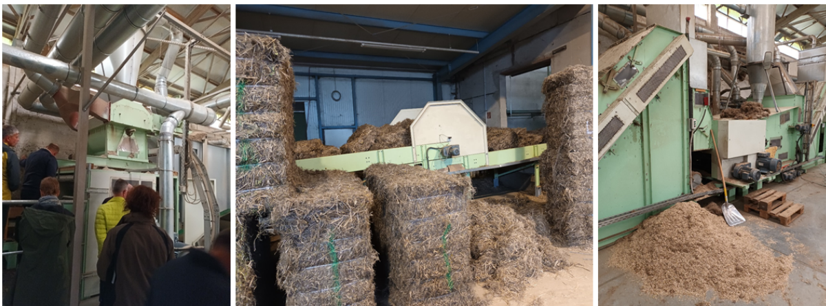
Herr Kolbe zeigt und erklärt uns, wie die Verarbeitungsanlage Hanfstroh (Mitte) in Schäben (rechts) und Fasern trennt.
